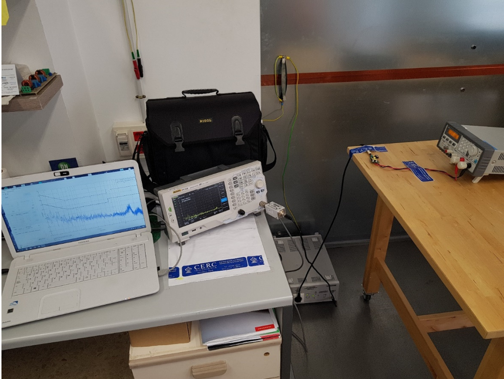
Fig. 3. Setup para ensayo de conducidas.
