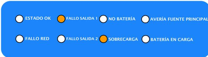
Led “Sobrecarga” amarillo fijo encendido e información de en qué salida se produce la sobrecarga, “fallo salida 1”. La salida 1 se desconecta, y la salida 2 opera con normalidad. La misma situación sería aplicable para la salida 2. Si la corriente de la salida 1 es de 3 A y la salida 2 solicita 4 A, se encenderá el Led de sobrecarga, así como el de la salida que mayor corriente pretende consumir, en este caso la salida 2.
