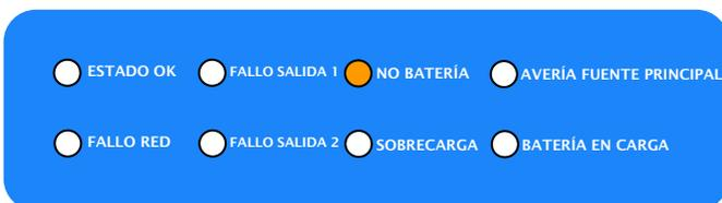
Led "no batería" amarillo fijo encendido. En caso de ausencia de baterías, defectos en los cables de conexionado de las mismas o fusible de batería fundido.
