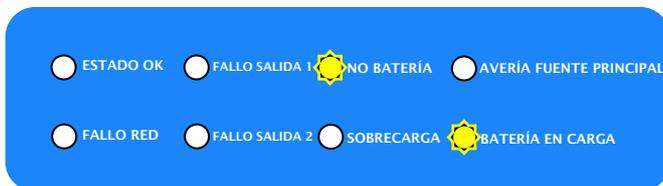
Led “No Batería” y “Batería en carga” encendidos amarillo intermitente. Las baterías no han superado el test de batería. Estas no garantizan la autonomía que exige la norma EN-54-4, están con un nivel muy bajo de carga. Las baterías se pueden recargar y empieza un proceso de carga de baterías para recuperarlas.
