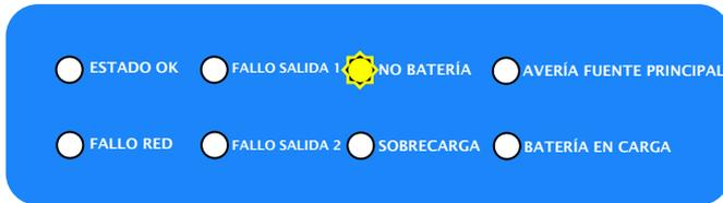
Led “No Batería” encendido amarillo intermitente. Las baterías no han superado el test de batería. El estado de las baterías no garantiza la autonomía que exige la norma EN54-4 y por lo tanto se han de reponer ya que han llegado a su fin de vida.
