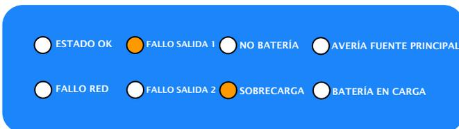
Led “Fallo Salida 1” amarillo fijo encendido. La salida 1 se desconecta, y la salida 2 opera con normalidad. La misma situación sería aplicable para la salida 2. En función del nivel de severidad del cortocircuito, es posible que la salida contraria a la que se esté realizando el cortocircuito se pueda ver afectada momentáneamente, transcurridos unos milisegundos se recupera.
